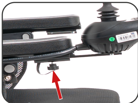
Ilustracja 12. Śruba regulacji panelu sterowania.
