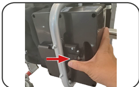
Ilustracja 9. Montaż i demontaż akumulatora.
