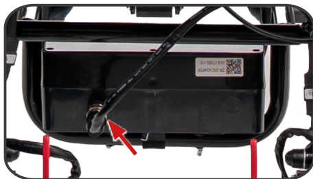
Ilustracja 8. Wpięcie złącza zasilania akumulatorów.
